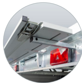
Achterklep ondersteuning d.m.v. uittrekkers
